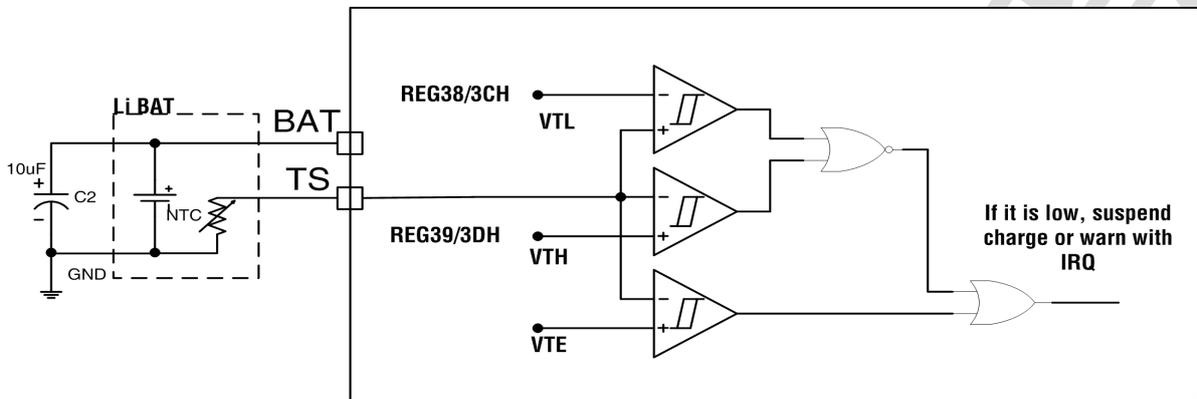
在上图中, VTH/VTL 分别为高温和低温的门限设置, 可分别通过寄存器 REG38H/39H/3CH/3DH 设置, VTE=0.2V。建议温敏电阻选用 25°C 时为 10KOhm、精度 1% 的 NTC 温敏电阻。AXP221 将在 TS 管脚上送出恒定电流, 此电流可设置为 20uA、40uA、60uA、80uA 四种 (参见寄存器 REG84H), 以适应不同的 NTC 电阻。此电流流过温敏电阻, 得到一个检测电压, AXP221 通过 ADC 测出电压值并与设置值进行比较, 从而发出相应的 IRQ 或是暂停充电。
